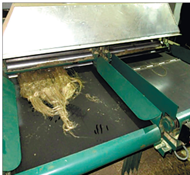
Рисунок 1. Машина мяльно-трепальная однопроцессная двухручье́вая марки МТОФ-1М: слева – технологическая схема; справа – вид со стороны питающего транспортёра: 1 – рама; 2 – транспортёр питающий; 3 – мяльный модуль; 4 – барабаны трепальные; 5 – бункер отходов трепания.
